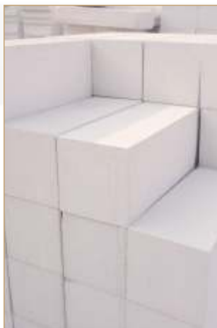
Наружные и межкомнатные стены- газоблок
